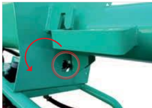
Senzor de siguranță deschidere camera de amestecare
