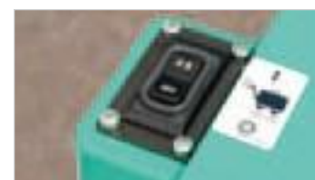
Întrerupător de activare a fricțiunii electromagnetice pentru vibrații
