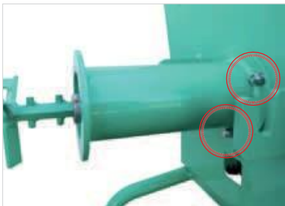
Tub direcționare material ușor de înlocuit
